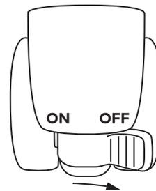
Чтобы включить блокировку колес, передвиньте переключатель до щелка в положение OFF на всех колесах, и в положение ON, чтобы выключить.
