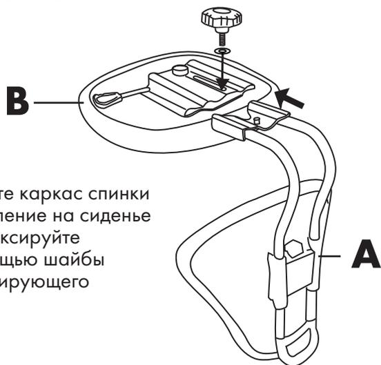
Вставьте каркас спинки в крепление на сиденье и зафиксируйте с помощью шайбы и фиксирующего винта.
